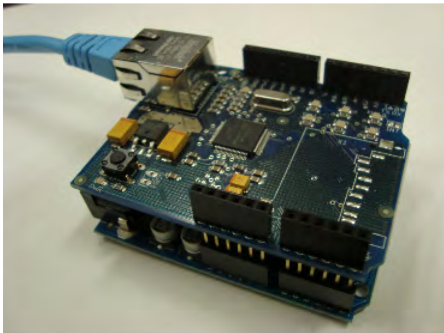
図 3.2 Arduino ボードとその上にスタックされた Arduino Ethernet Shield
