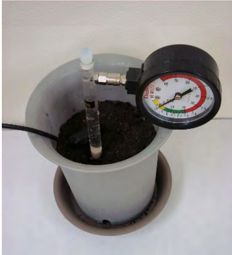
図 2.11 pF 値と出力電圧の測定の様子
