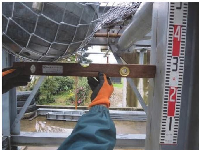
写真-6. 6 面外動的試験状況(たわみ量計測)
