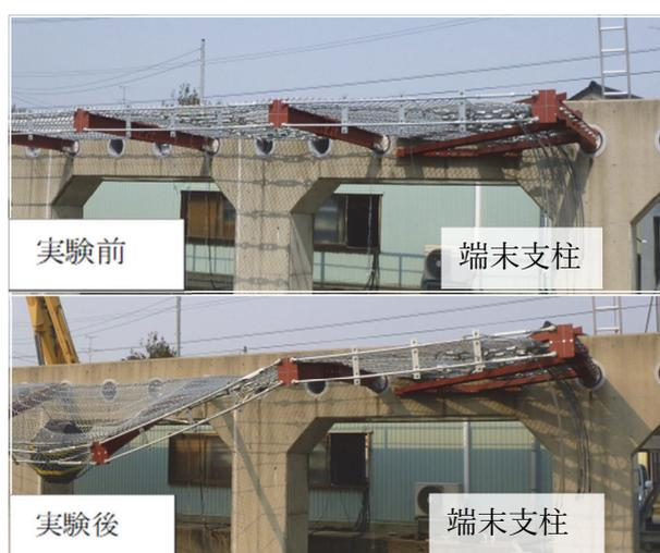
写真-5. 11 端末支柱の変形状況 (CASE-3)
