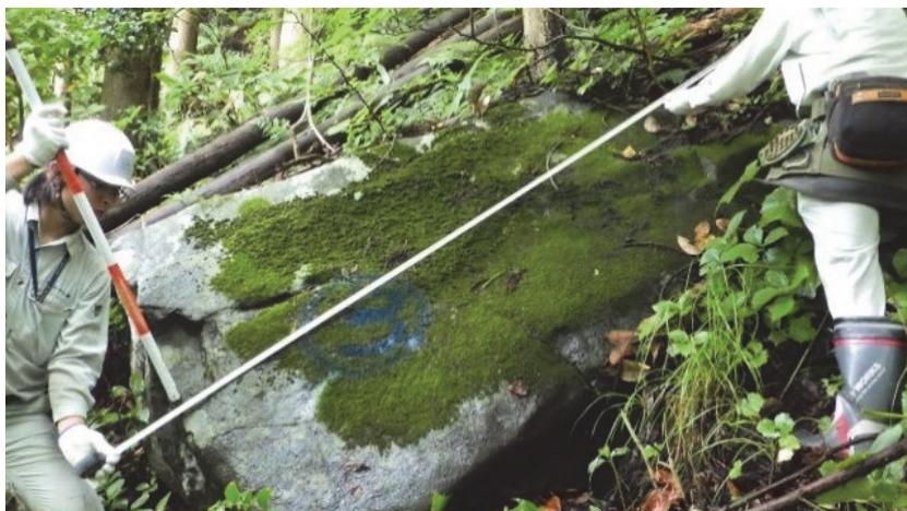
写真-4. 1 標尺を用いた落石径計測
