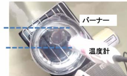
図 4. 直上から見た半底加熱のビーカー配置
