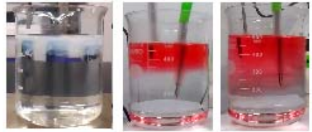
図7. 加熱なし 500 mL 水への注入(左: 70 °C アクリル絵の具ろ液注入+24秒, 中: 90 °C 食紅液 15 mL 注入+2分50秒, 右: 62 °C 食紅液 15 mL 注入+40秒)
