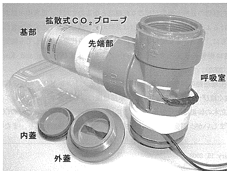
図-1. 幹木部組織片用呼吸量測定器 プローブ先端部にある分析ユニットのエアサンプル室が呼吸室に取り込まれている。
