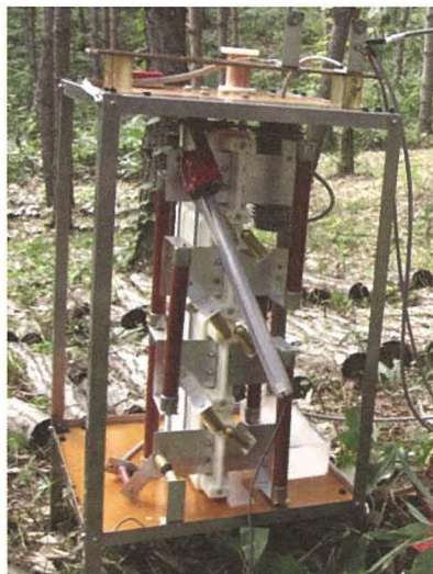
図1 開発・改良した Marx-IES 方式パルスパワー発生装置(最大出力:約 500kV)
