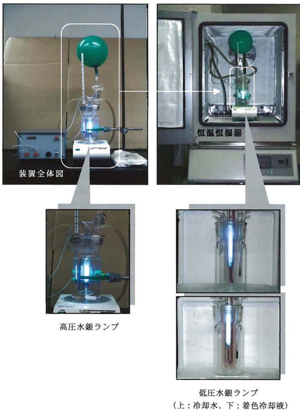
図5.5 水銀ランプ照射によるB(a)P光分解実験の様子
