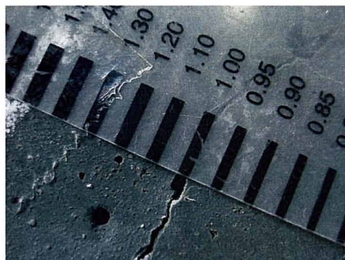
写真 5-3 300 サイクルの凍結融解試験終了後の劣化状態 (No.10, W/C=40%, Air=6%, 単位：mm)
