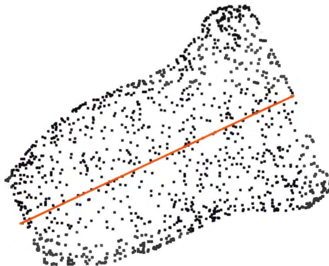
図 4.4: 点群グループと線分化された主軸
