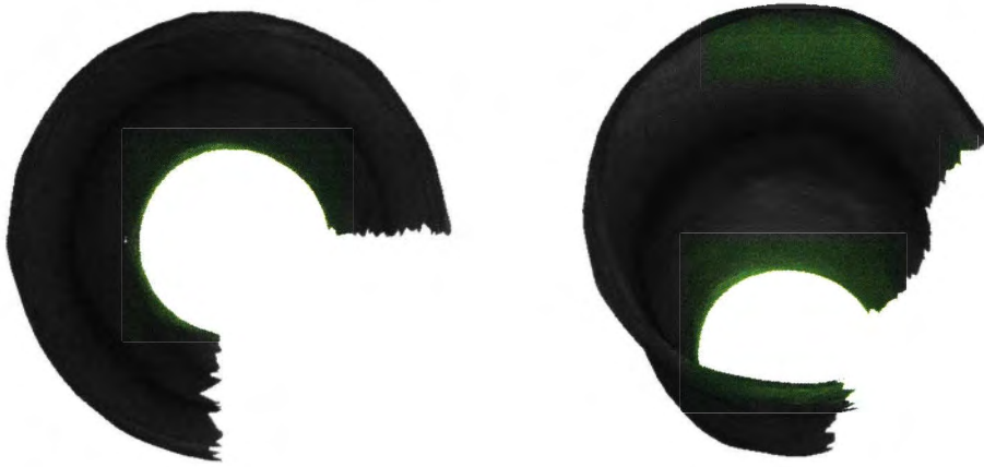
図 4.14: スムージングした点群から 90 度分のデータを削除したポリゴン
