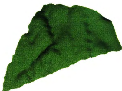
(b) パスバンド曲率 0.1 で Taubin のフィルタを適用したポリゴン
