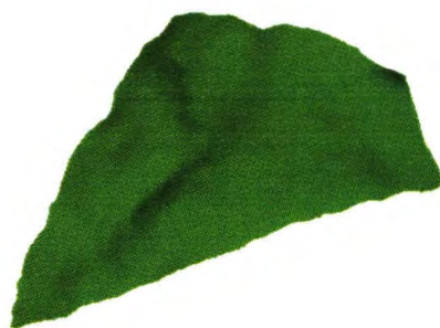
(c) パスバンド曲率 0.01 で Taubin のフィルタを適用したポリゴン
