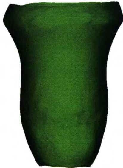
(b) Taubin の手法でスムージングをしたポリゴン
