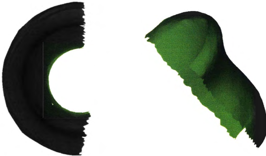
図 4.15: スムージングした点群から 180 度分のデータを削除したポリゴン
