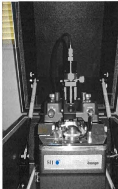
図 2-23 本研究で用いた AFM 装置の SPA-400.
