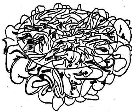
図1-6 共晶セル中の片状黒鉛立体構造 10)
