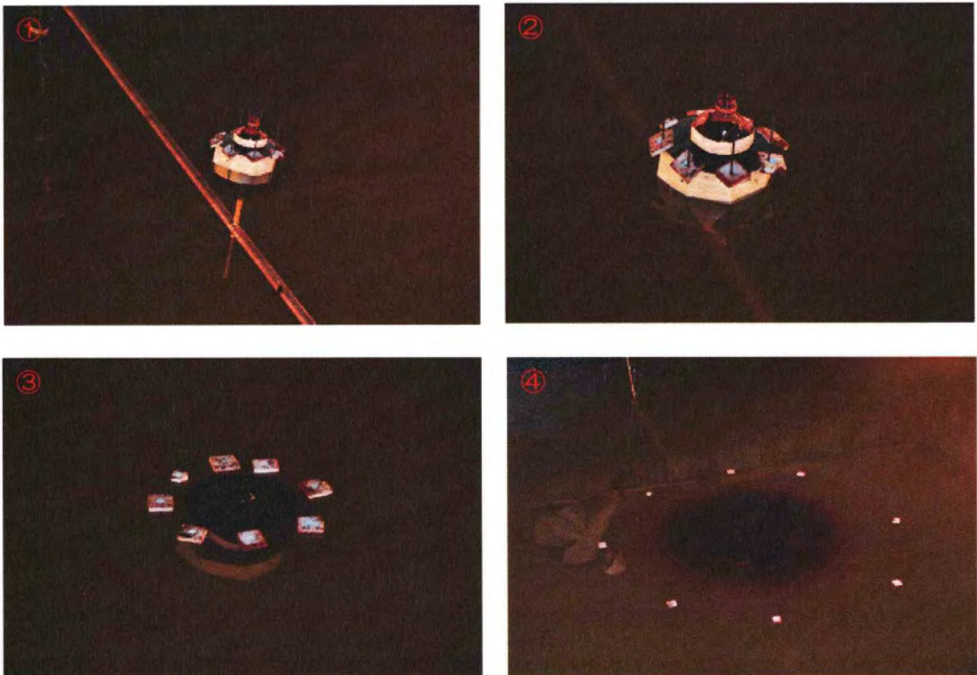
図 3.3.10: 大型水槽で油が拡がる様子（時間経過と共に 1 から 4 の順番）
