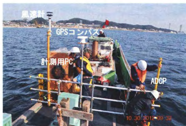
図 4.3.3: 風況及び流況データ計測方法
