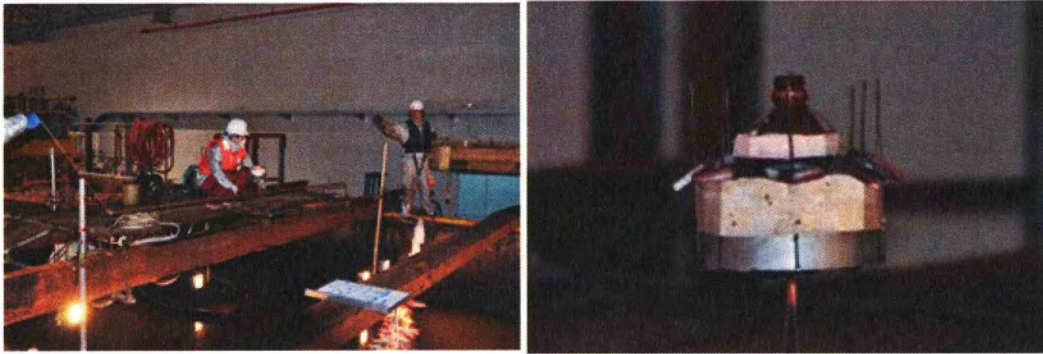
図 3.3.9: 大型水槽で用いた油投入器（左：全体図，右：2重円筒の油投入器）
