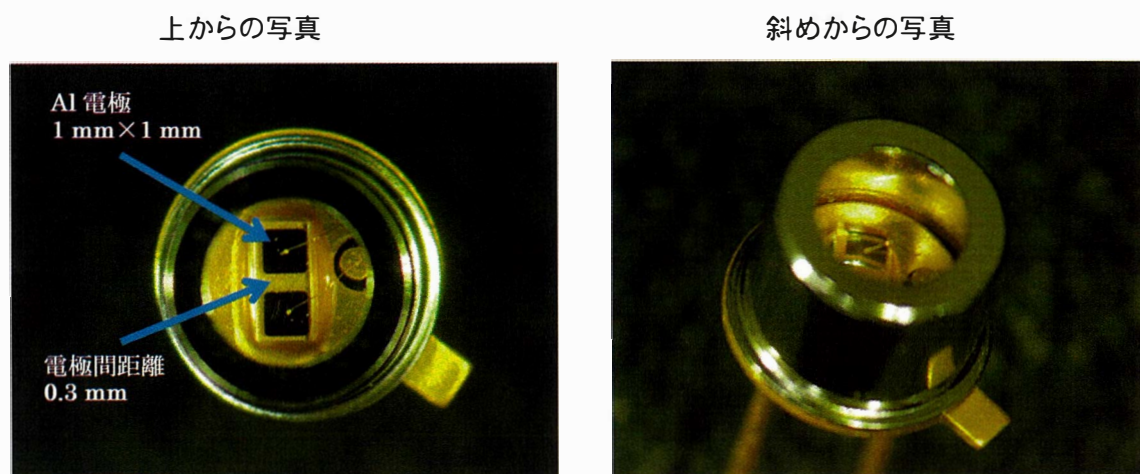
図 6-1 試作した ZnO-UV センサ素子と缶パッケージの様子
