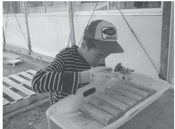
写真6 ユニットに塗装を行う様子
