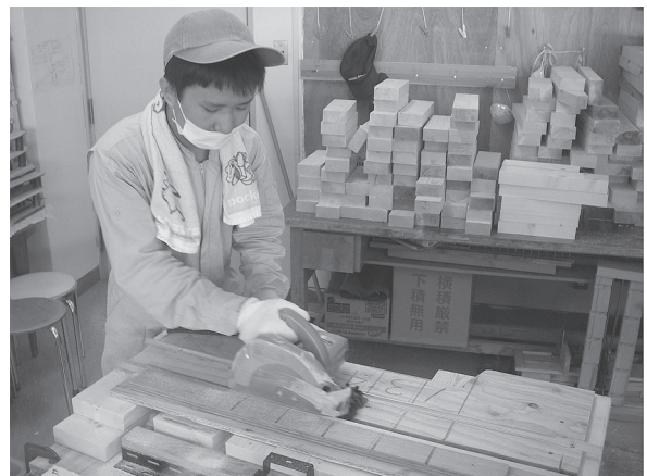
写真7 丸鋸で廃材を切断する様子
