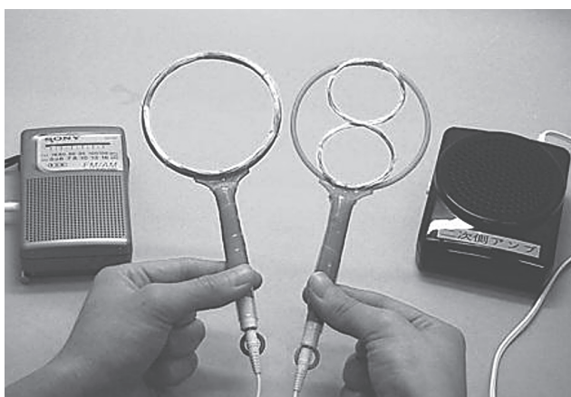
(図1) 「8の字コイル」での電磁実験装置 (左；SONY・ICF-P21、右；NEW ONLINE・N74)
