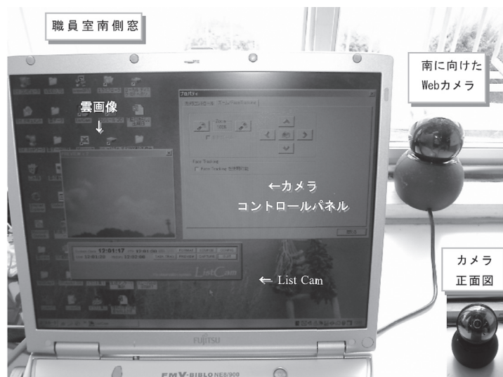
図1 職員室南側に設置した観察システム全体構成 (職員室南側窓際の棚に置いたPCとWebカメラ)
