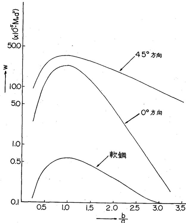
図3 縁 $y = \pm \frac{b}{2}$ に曲げモーメントを有する3種の矩形板の中央における撓み
