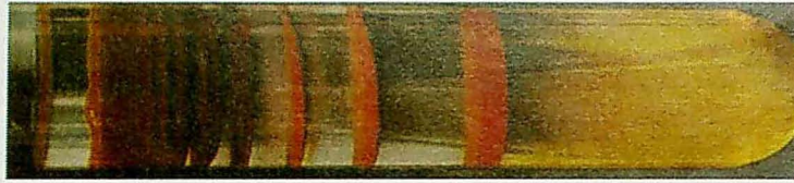
図 1: リーゼガングバンド. 図左側が試験管上部であり, 試験管上部より反応がすすみ, バンドパターンが得られる. 文献 [3] より転載.
