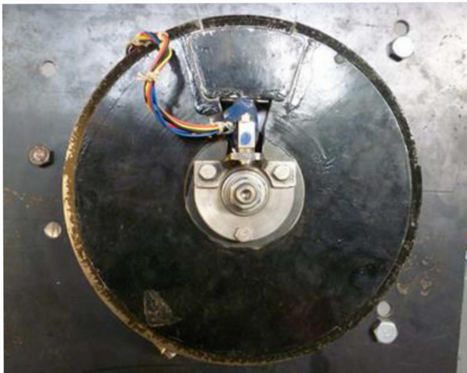
图 3.8 刃缘部测定装置组立图
