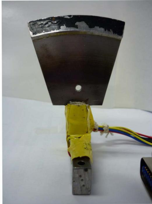
图 3.7 刃缘部测定装置
