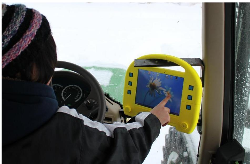
図 3-11 トラクタに設置したトラクタ用フィールドコンピュータ
