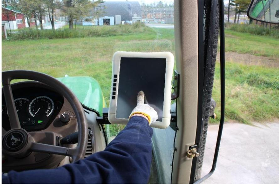
図 3-3 トラクタに設置したトラクタ用フィールドコンピュータ
