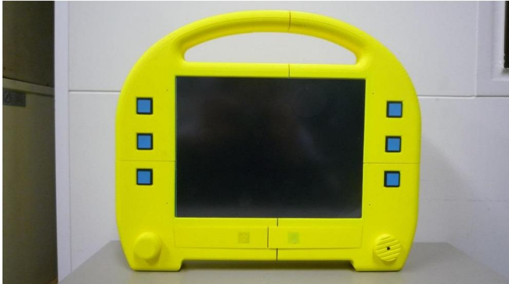
図 3-9 トラクタ用フィールドコンピュータ（試作 2 号機）の外観
