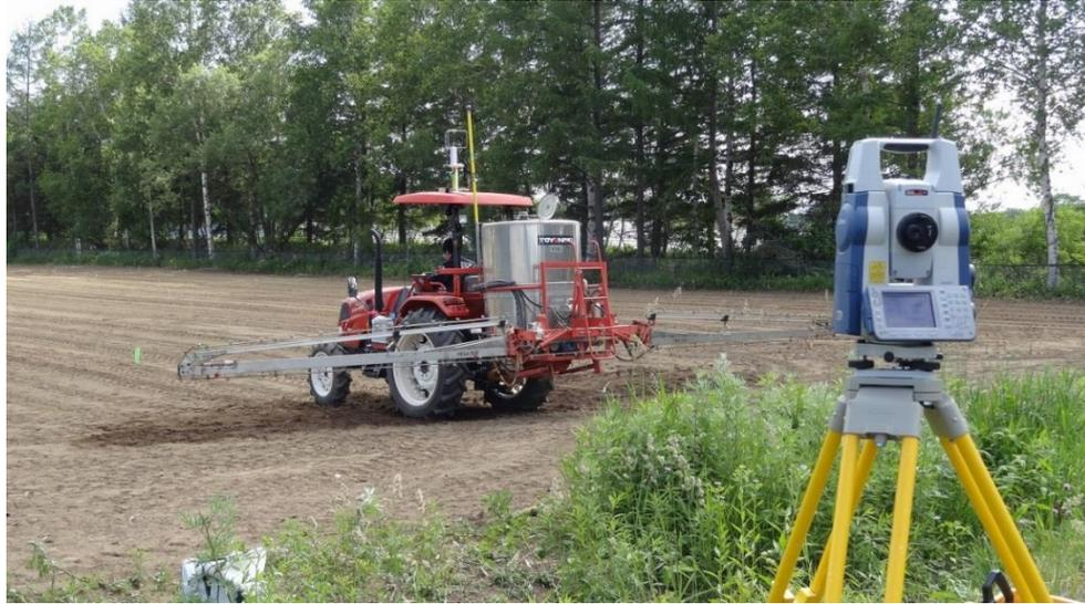
図 5-2 トータルステーションを利用した作業位置の計測
