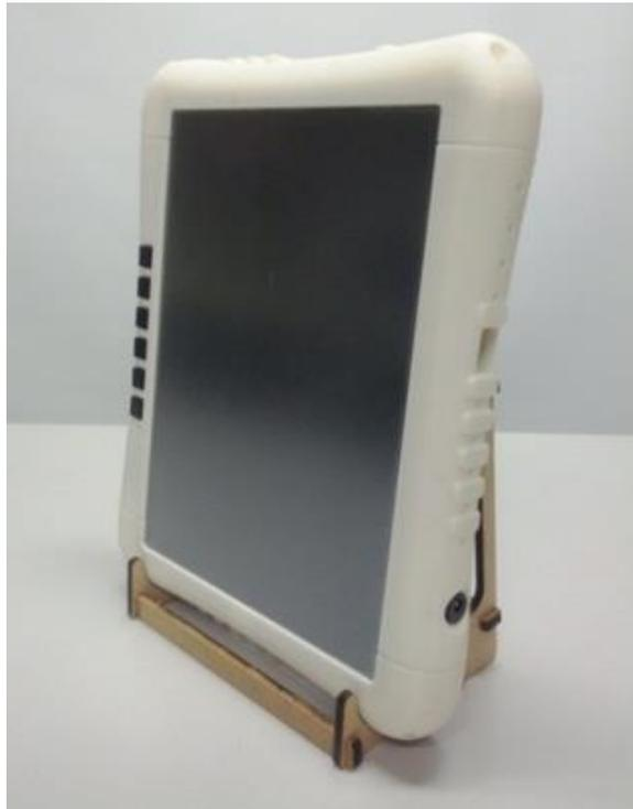
図 3-1 トラクタ用フィールドコンピュータ（試作 1 号機）の外観
