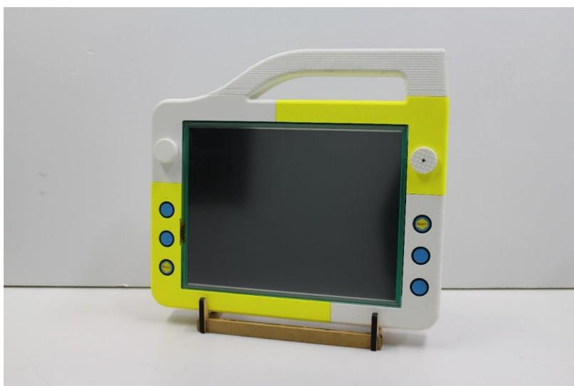
図 3-16 トラクタ用フィールドコンピュータ（試作 3 号機）の外観
