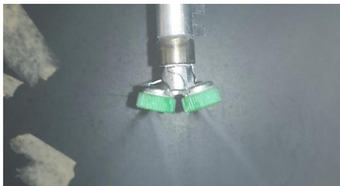
図 4-8 供試したカニ目 2 頭口ディスク型ノズル
