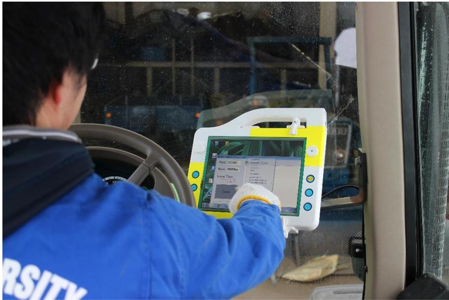
図 3-18 トラクタに設置したトラクタ用フィールドコンピュータ
