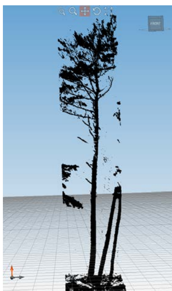
図 2.10 林内 3D デジタルスキャン解析ソフト Digital Forest による森林のデジタルドキュメント化 上：個体位置と位置・個体諸量，下左：個体 3D 表示，下右：幹形状（10cm 間隔で中心座標と直径を測定している）。
