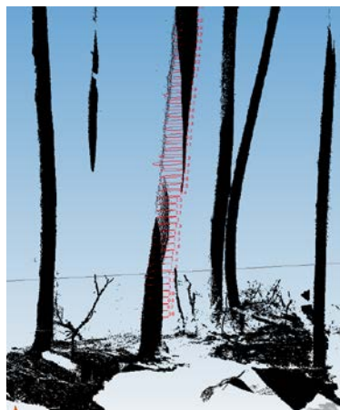
図 2.10 林内 3D デジタルスキャン解析ソフト Digital Forest による森林のデジタルドキュメント化 上：個体位置と位置・個体諸量，下左：個体 3D 表示，下右：幹形状（10cm 間隔で中心座標と直径を測定している）。
