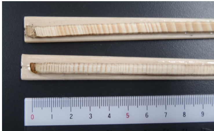
図 3.3 年輪コアによる肥大成長経過の測定
