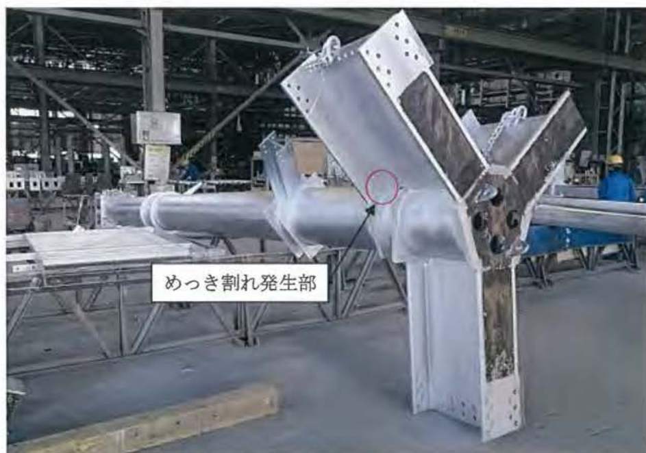
図 1-1-2 めっき割れが発生した柱材の全体図
