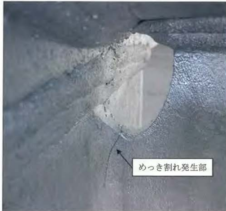
図 1-1-3 柱材のスカラップめっき割れ拡大図
