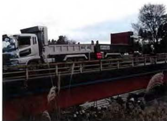
写真-3.2 静的載荷試験状況
