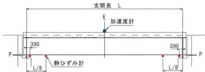
図-5.8 動的載荷試験の測定機器設置図
