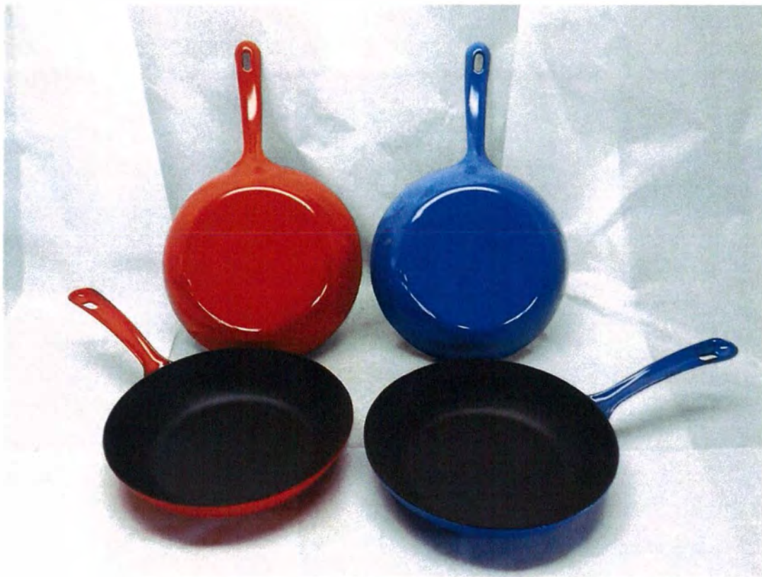
図 5-14 試作品 球状黒鉛鑄鉄 (シェル型 : C3.59%、Si2.50%)
