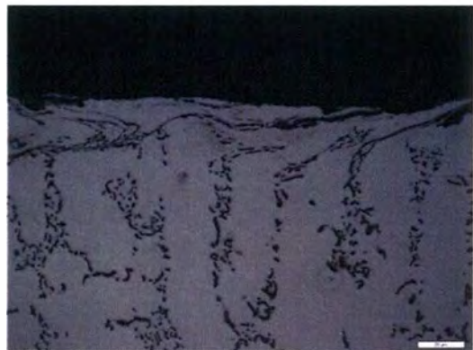
図 4-12 C2.3%、Si4.0%試験片のショット投射前後の組織
