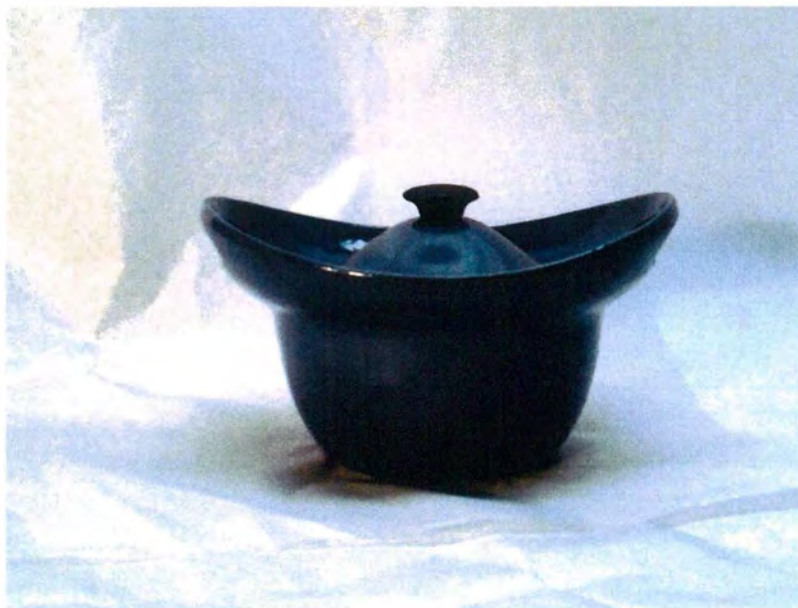
図 5-13 試作品 片状黒鉛鋳鉄（生型：C3.67%、Si2.22%）
