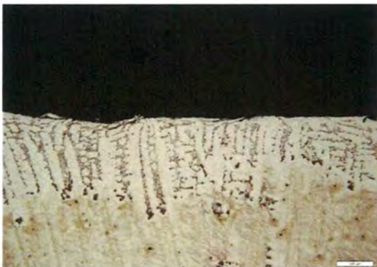
図 4-12 C2.3%、Si4.0%試験片のショット投射前後の組織
