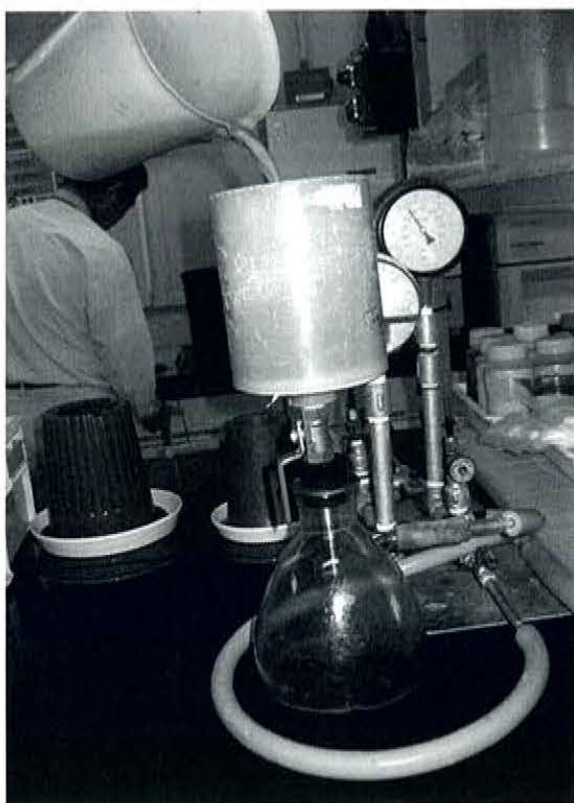
図 - 4 . 3 リン酸スラリーのろ過試験の写真
