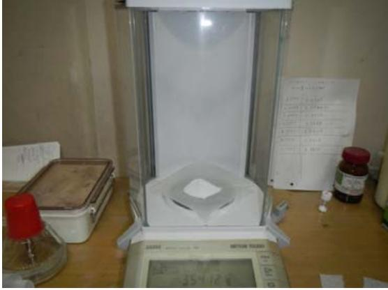
図 5-7: 粉末の試料を 3.2g 計りとる.
