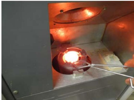
図 5-6 ビードサンプラーで攪拌する.
