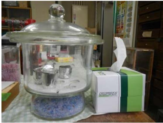
図 5-4:デシケータによって放冷する.
