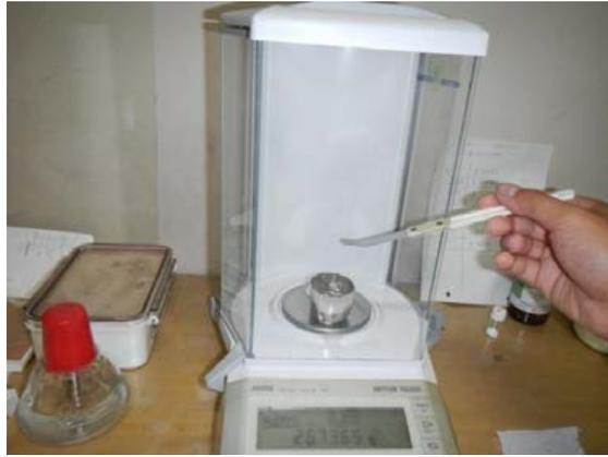
図 5-2:試料を計り取る.
