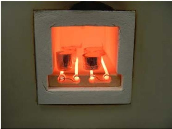
図 5-3:マッフル炉で強熱する.
