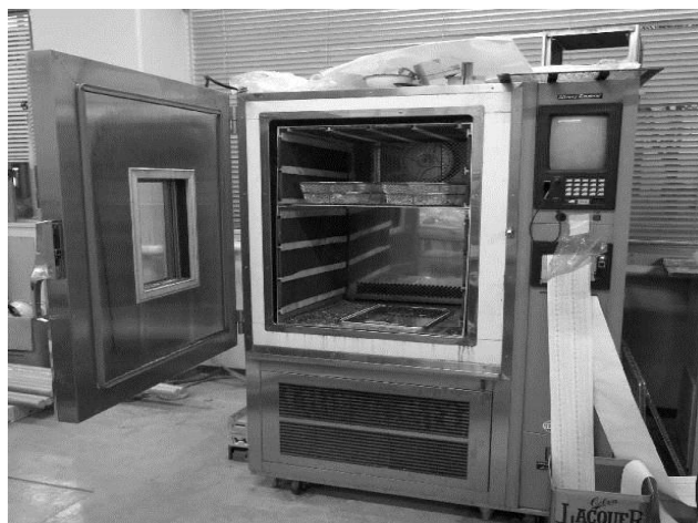
図 3.5 恒温恒湿機の外観
