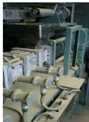
図 4.3 二軸エクストルーダー (上の円筒が投入口、調整可能)
