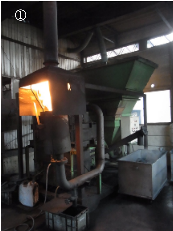
図 3-5 アイセック社製 TM-50 送風型籾殻燻炭装置
