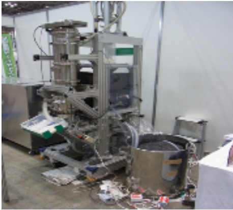
図 2-41 循環型衝撃波粉砕装置
