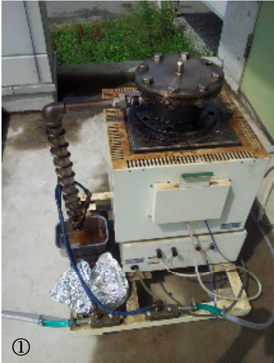
図 3-4 蓄熱分解物回収装置
