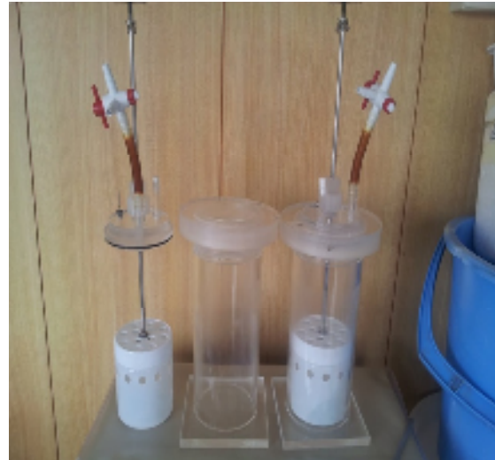
図 5-6 発酵槽と飼料容器(白い部分)
