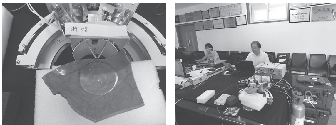
図1 XRDF測定時のキャピラリーと試料の位置関係（左）ならびに浙江省文物考古研究所でのXRDFの設置（右）
