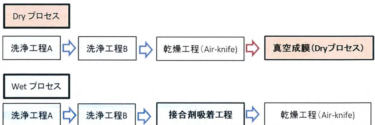
Fig. 1.2 Dry プロセスと Wet プロセスのフロー比較
