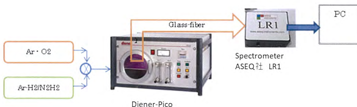
Fig. 2.1 プラズマ発光スペクトル測定ブロック図
