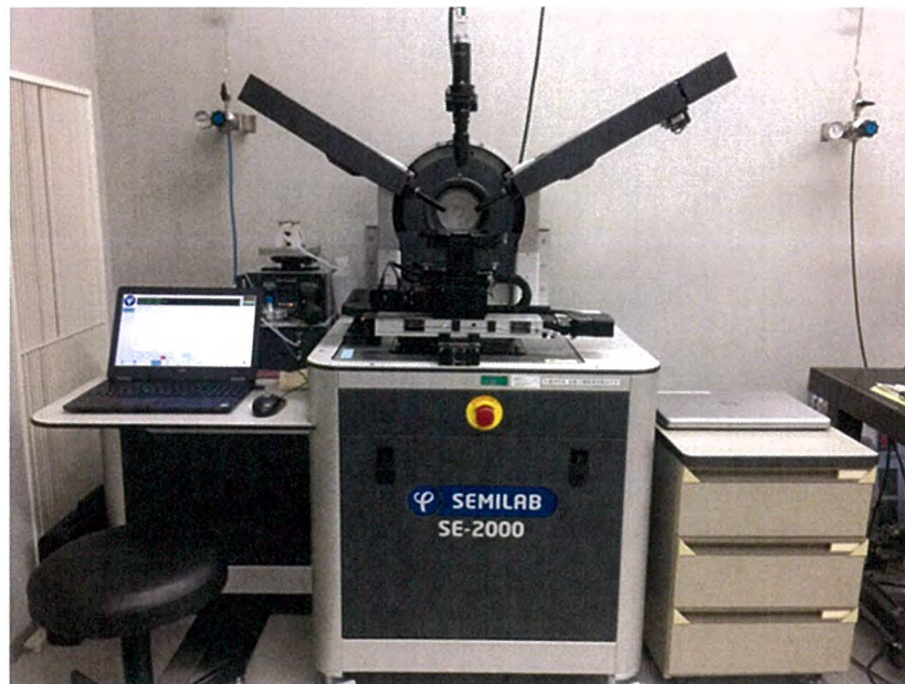
Fig.5.2 分光エリプソメータ (SE-2000)
