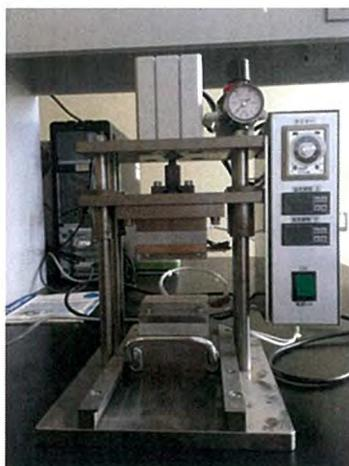
Fig. 6.1 アシリンダー式加熱圧着層
