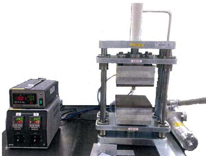
Fig. 6.3 油圧式加熱圧着装置
