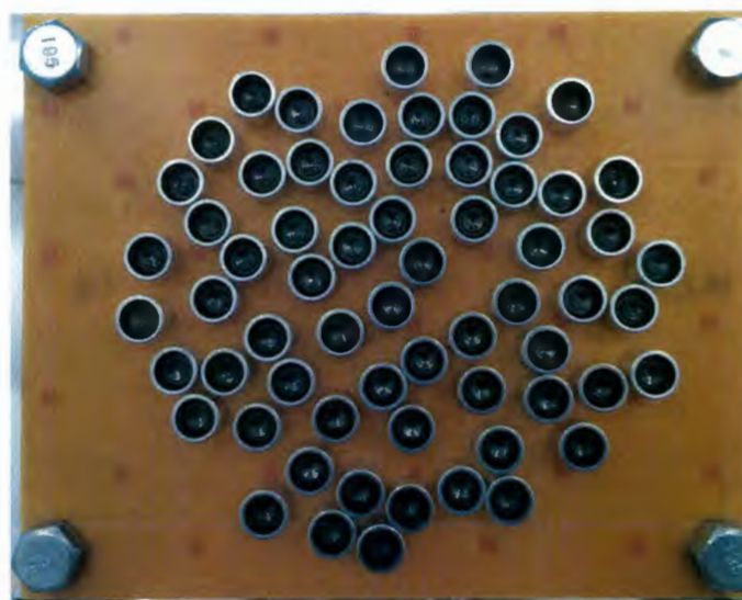
図 6 ランダム素子配置パラメトリックスピーカ
