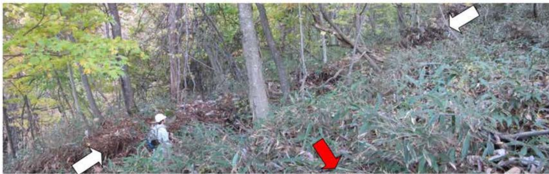
Photo Ⅲ-2 線状凹地内で確認された亀裂（白矢印）。亀裂より手前側の斜面が赤矢印（北西）方向に変形していた。村上ほか（2013b）より引用，改訂。
