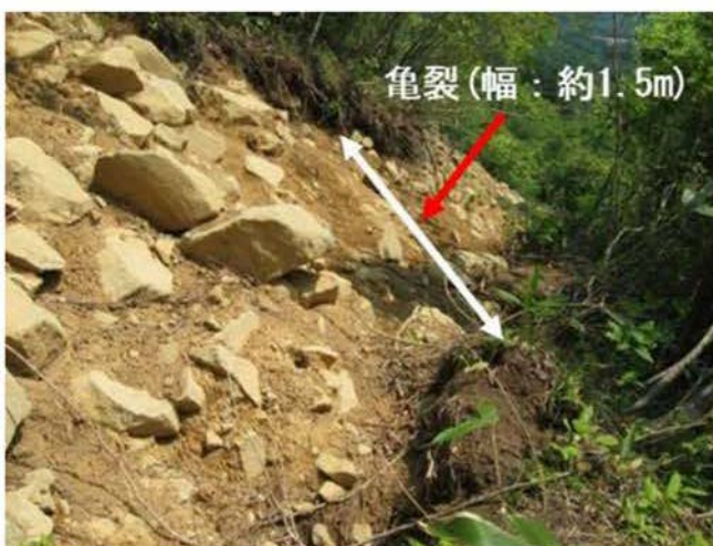
PhotoIII-3 A1 の崩壊斜面源頭部で確認した亀裂。2009年6月26日撮影。写真の撮影位置はFig. III-5aに示す。村上ほか（2017）より引用。
