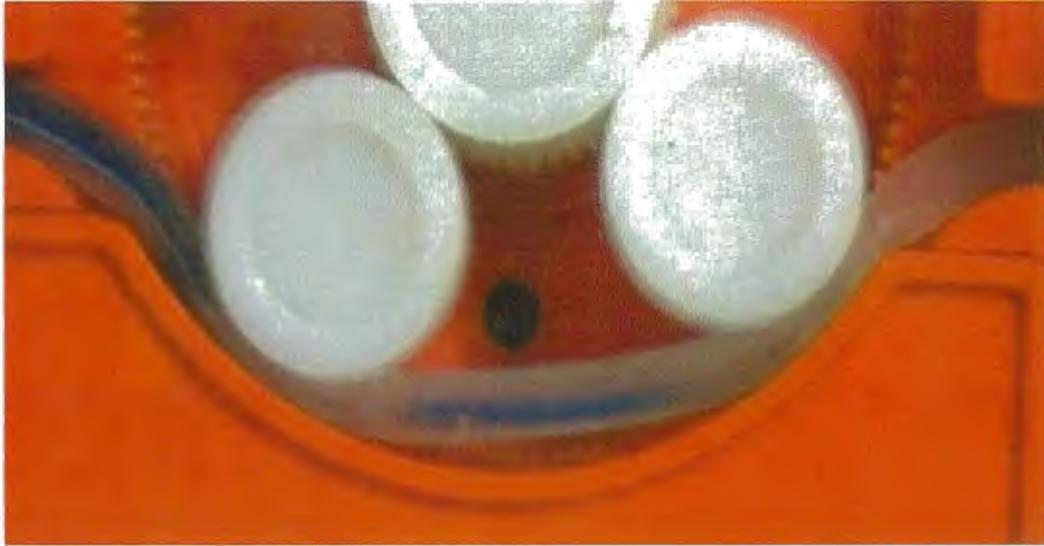
図8 チューブを押しつぶした位置の間に密封された流体
