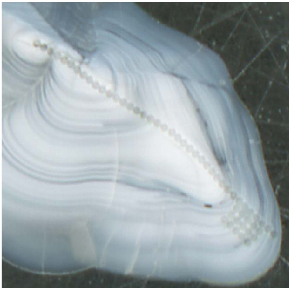
Fig.7 LA-ICP-MS による分析後の試料表面（耳石上の連続した円はレーザー照射痕．図中左上の耳石核から右下の縁辺部に向かって連続的に分析点を設定した）
