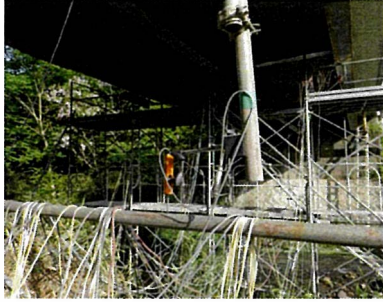
図-2.8 計測機器設置状況(鉛直変位・水平変位設置状況)
