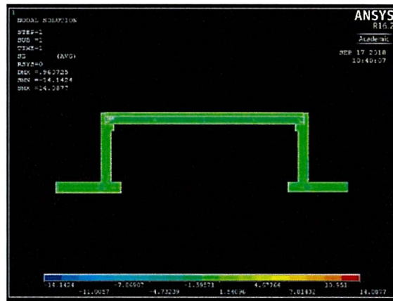
図-25 応力コンタ図(荷重無) (支点条件 Pin-Roller)
