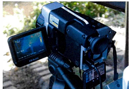
図-2.10 計測機器設置状況(ひずみゲージ設置・赤外線サーモグラフィー)
