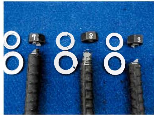
写真-3.2.6 ネジ試験片破壊状況
