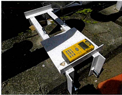
図-2.9 計測機器設置状況(橋台間計測レーザー距離計)
