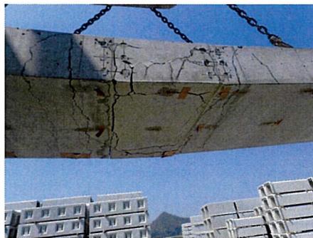
図-4.1.20 4点曲げ試験破壊状況 (継手あり)
