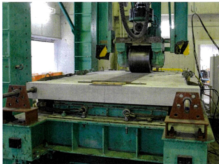
図-4.2.6 輪荷重走行疲労試験の状況
