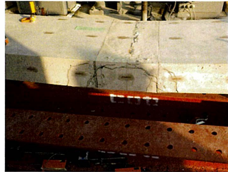
図-4.1.25 3点曲げ試験破壊状況 (継手あり)
