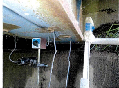
図-2.8 計測機器設置状況(鉛直変位・水平変位設置状況)
