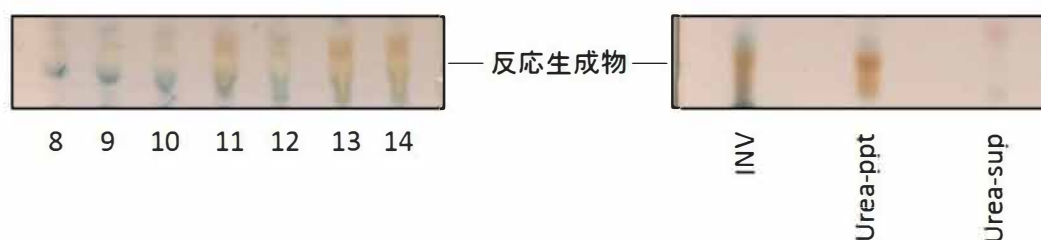
図6 精製画分のCompound I 生合成活性。INVを可溶化し、陰イオン交換クロマトグラフィを用いて分画した。各画分と、PAおよびUDP-GlcNAcを混合し、37°Cで保温後にTLC展開した。左側のプレートは精製画分の活性を示している。プレートの下に数字はクロマトグラフィにおける溶出画分の番号を示している。このうち最も強い活性を示した13番目の画分に対してLC-MSを用いた構造解析を行った。右側のプレートは精製画分の代わりにINV、尿素洗浄膜、尿素洗浄後の上清を用いた際の結果を示している。
