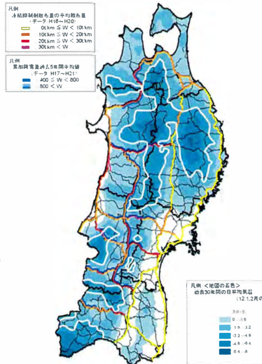
図 6.12 凍害区分 3 以上の地域と凍結抑制剤の散布量の関係 6-4)
