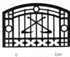
図12 資料館の基礎煉瓦換気口グリル
