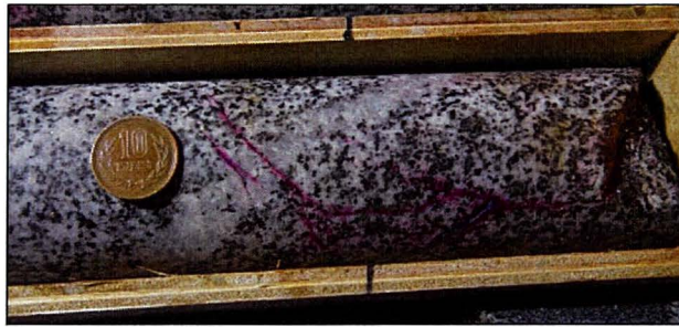
写真 3.3.4 極超微粒子セメントの充填状況 (微細な割れ目に充填されたセメントが フェノールフタレインにより赤色に発色)
