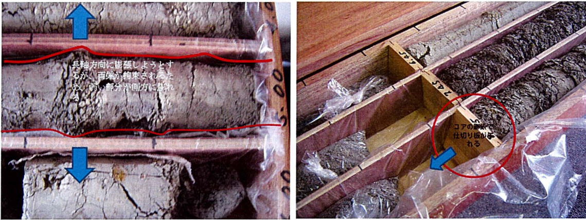
写真4.7.1 石膏の生成とコアの押し出し
