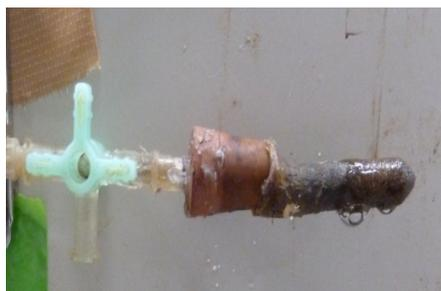
写真 2-1 圧力水頭測定用フィルター
