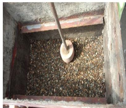
写真 2-3 各層の突き固め
