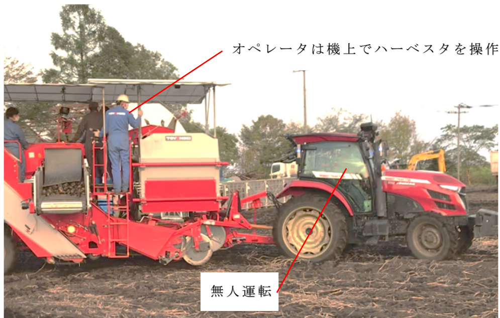
図 5-8 無人走行での旋回時の様子
