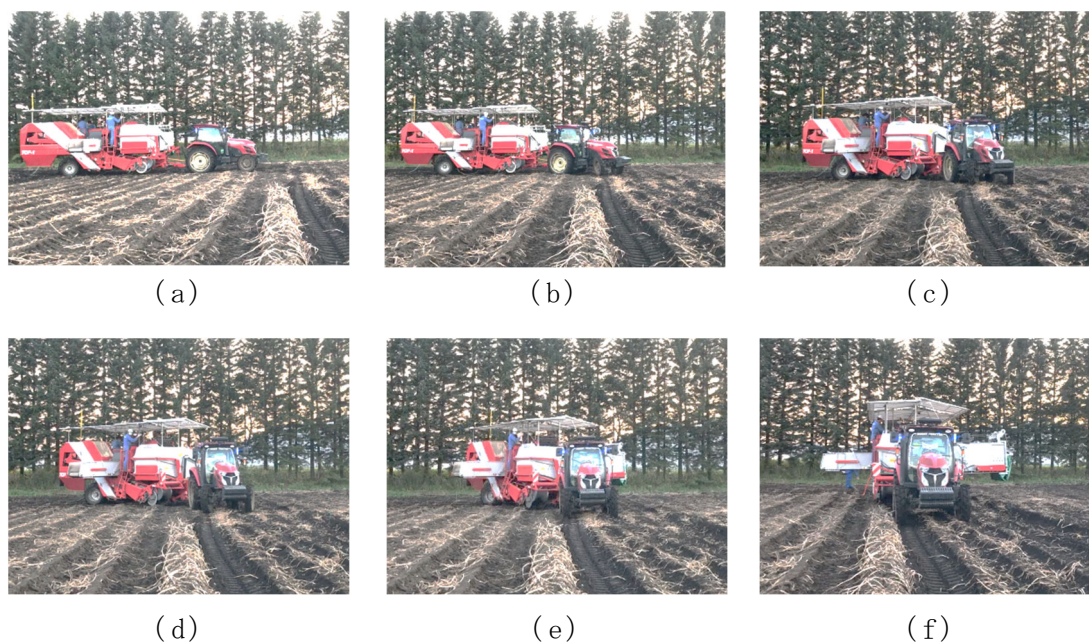
図 5-11 無人走行で枕地旋回して畝に入る状況
