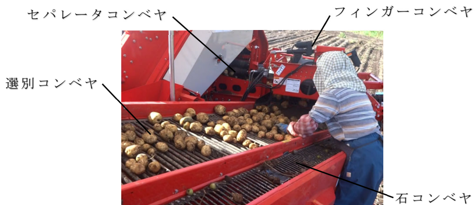
図 4-2 国産オフセット式ポテトハーベスタのコンベヤ配置
