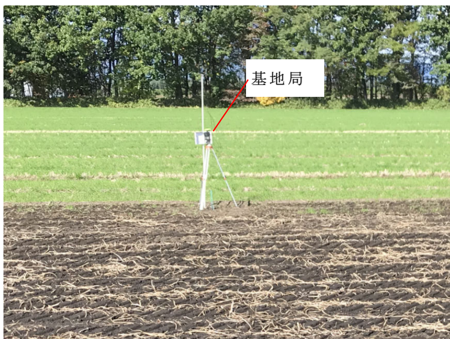
図 5-3 位置情報を補正するための基地局
