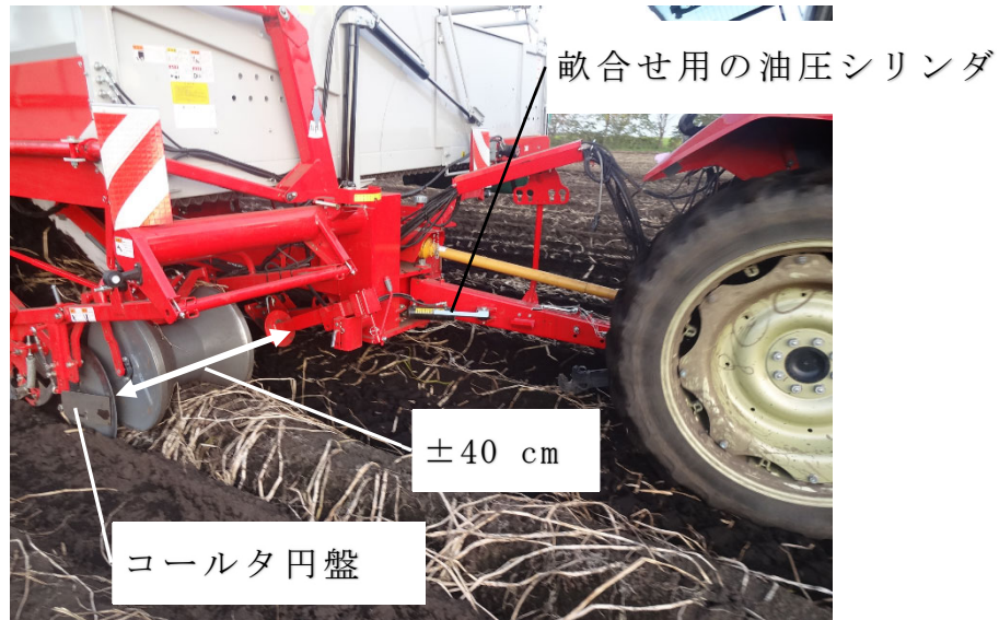
図 5-13 掘取部の概要
