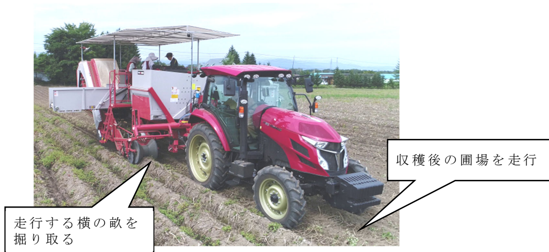
図 2-3 オフセット式のポテトハーベスタの例
