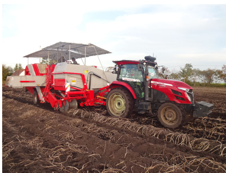
図 5-10 無人走行による掘取作業
