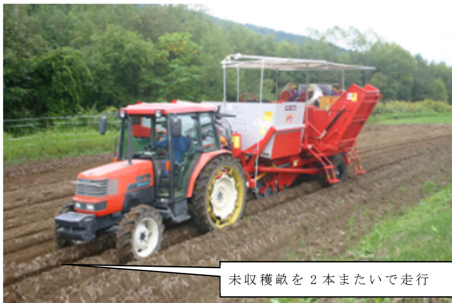
図2-1 インライン式のポテトハーベスタの例
