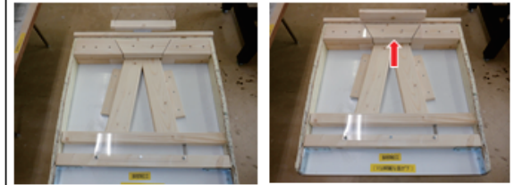
【写真3】台形部材をセット 【写真4】防護用のアクリル板をセット
