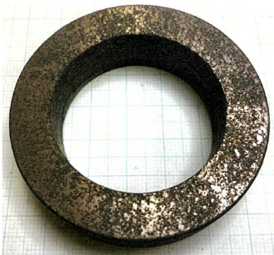
図 4.4 作製した外径 60 mm、内径 (a) 40 mm または (b) 30 mm、厚さ 15 mm のリングバルク外観写真
