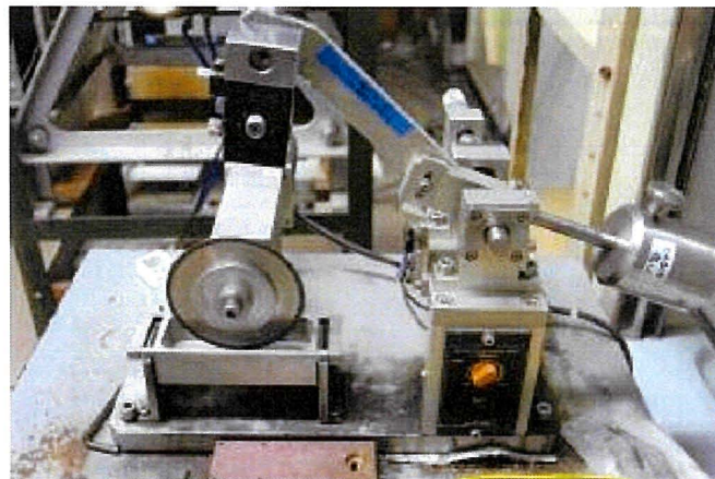
図 2.2 ダイヤモンドカッター
