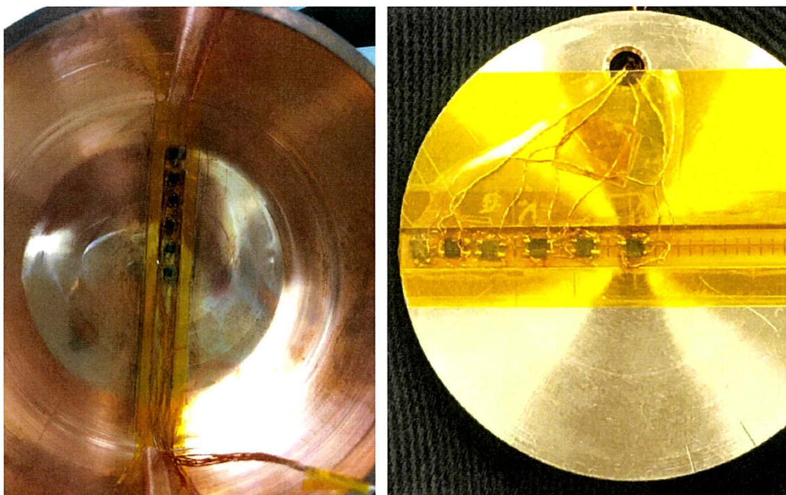
図 5.4 (a) バルク表面の捕捉磁場分布を測定するためのホールセンサーユニット (b) リングバルクのボア内捕捉磁場分布を測定するためのホールセンサーユニット
