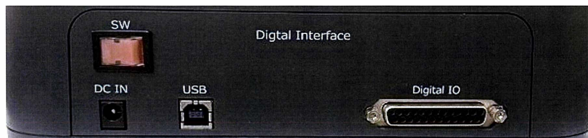
(c) 側面 2: USB ケーブル・バッテリー接続パネル
