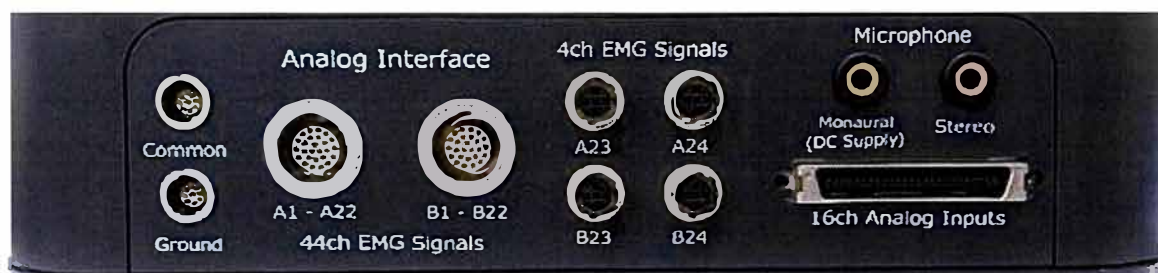
(b) 側面 1: 多チャンネル電極接続パネル
