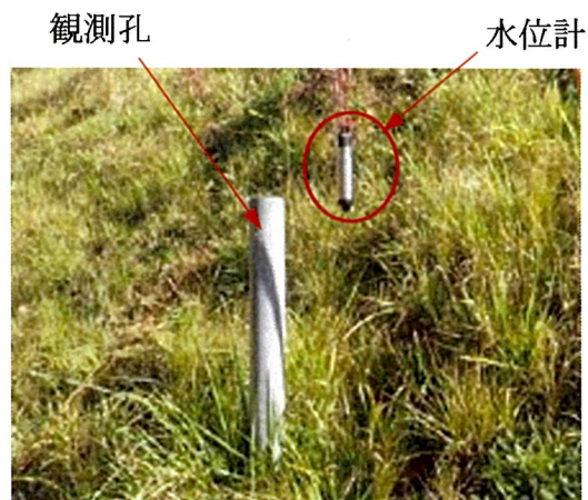
写真 3.6.1 B4 における注水試験の状況
