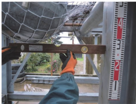
写真－6 面外動的試験状況（たわみ量計測） Photo 6 Out-plane dynamic test status (deflection measurement)
