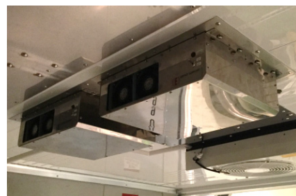
図 1 産学連携によって開発され香港への輸送コンテナに搭載されたエチレン分解(青果物鮮度保持)装置の写真
